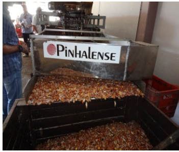
Salida de almendra del despulpador para la caja de fermentación
