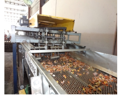
Transportador vibratorio para separación de la cáscara
