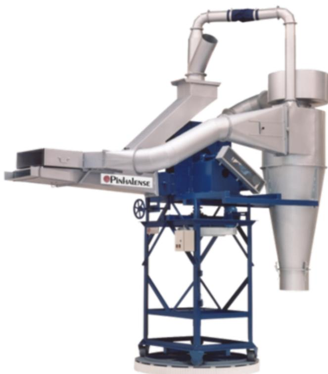
El ventilador del CPC y la forma de su pico con altura ajustable fueron especialmente diseñados para evadir daño a los granos; no se produce en absoluto. El ventilador también es compatible con la succión de polvo por el ciclón que puede o no ser operado dependiendo del tipo y limpieza del café cargado, de los requerimientos del importador o exportador, y estrategias para asegurar que el peso contratado es entregado.
