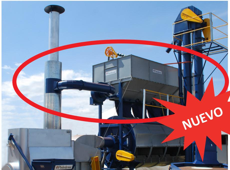
Aunque un secador estático no homogeniza la humedad del café entrante, el secador rotativo SRE desempeñará esta tarea luego. Este será el caso también para los lotes que llegan con café presentando una buena dispersión de contenido de humedad y que no pueden ser homogenizados en un secador estático solamente.
