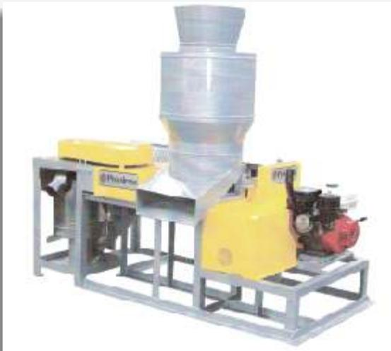
Diseñado para una capacidad de 500 a 1.000 kg/hora de cereza fresca de café, el más básico beneficio húmedo compacto **ecoflex** sólo tendrá un despulpador vertical de dos cilindros. El más completo beneficio húmedo compacto **ecoflex** estará equipado con:
