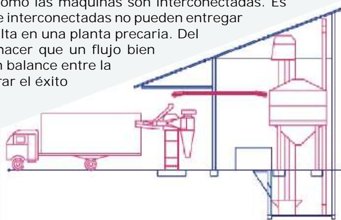
Flujos eficientes diseñados por Pinhalense y sus equipos de manejo de producto de tecnología de punta, "los héroes ocultos", evitan problemas con elevadores que se traban o dañan el café (un elevador de café es muy diferente a uno de granos), transportadores que derraman el café, silos que no llenan o no se descargan completamente, unidades de mezclado que no producen una mezcla uniforme, estaciones de pesado que no son exactas, o congestión indeseada en el área de producto terminado.
