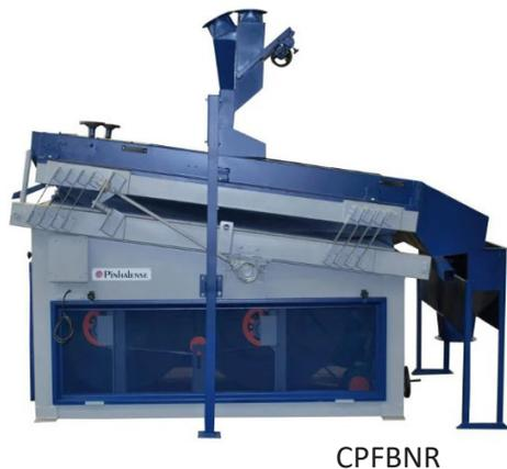
皮亚兰斯 (Pinhalense) 研制的精确、低功耗、低噪音的流化床式除石机，其型号为CPF和CPFBNR，能有效去除咖啡中不同大小的石头和其他杂质，可用于处理咖啡干果、带壳豆和咖啡生豆。
